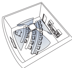
Направление всех четырех воздушных потоков из кассетного блока можно синхронно менять по вертикали.
